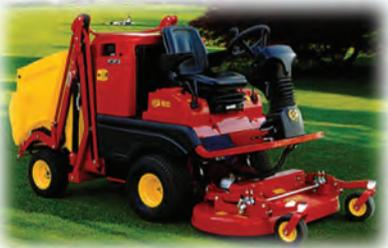
**GT Modell** – GT280D HE, wassergekühlter 3-Zylinder-Dieselmotor Benzin 28PS (20,6kW), Mähwerk- und Fahrtrieb hydraulisch, 550 Liter Fangbox mit Hochentleerung 180cm mit 80cm Ausladung, Mähwerk-Kippfunktion, Mähwerk- und Fangbox- Aushebung hydraulisch, wahlweise mit Allrad, STVZO erhältlich
