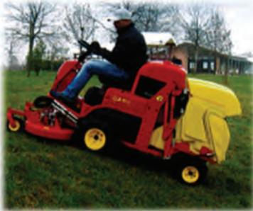
**GTS Modelle** – GTS 230, luftgekühlte Benzinmotoren 23PS, wahlweise mit Allradantrieb, Boden- und Hochentleerung, GTS 220D mit wassergekühlten 3 Zylinder-Kubota-Dieselmotoren, wahlweise mit Allradantrieb, Bodenentleerung 80 cm oder Hochentleerung 175cm bei 300l Fassungsvermögen, sowie STVZO
