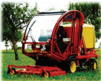
**T – Modelle** – 3 verschiedenen Modelle, T1 mit Dreizylinder Kubotadieselmotor, 28PS oder 33PS, ohne und mit Allradantrieb, T2 und T4, Vierzylinder Kubota-Dieselmotor 36PS und 44PS oder 50PS, ohne und mit Allradantrieb, hydrostatischer Fahrtrieb, Servolenkung – 55 cm Wenderadius, Sammelmähwerk 130, 150 oder 180 cm, je nach Typ 900 – 1400 l Fassungsvermögen, Entleerungshöhe 220cm, auch mit Kabine und STVZO
