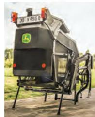
Im Fangkorb integrierte Abstellstützen ermöglichen werkzeuglosen Abbau, danach ist es möglich gezogene Anbaugeräte im Heck zu betreiben
