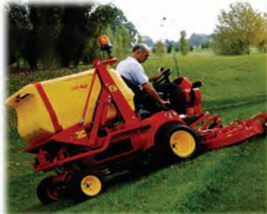
**PG Modelle** - 3 verschiedene Modelle, Benzin, Benzin mit Allrad, Diesel und Diesel mit Allrad, Benzinmodelle – luftgekühlte Briggs-Motoren mit 23 PS, Dieselmodelle – 3 Zylinder Kubota-Dieselmotoren mit 27 bzw. 30 PS, Alle Modelle mit Hochentleerung auf 180 cm, Fassungsvermögen 500l, Ausladung 80cm, Gewicht 800kg, Servolenkung
