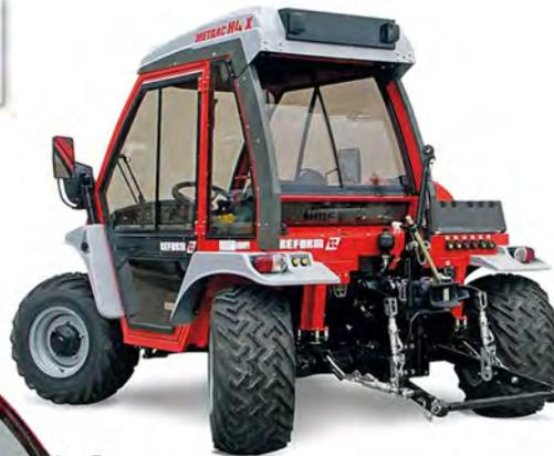
Der **Metrac H4 X** ist das kompakteste Modell mit hydrostatischem Antrieb und somit ein perfektes Einstiegsmodell in die stufenlose Anpassung der Fahrgeschwindigkeit. Dieser Mittelklasse Metrac überzeugt nicht nur durch seine einfache Bedienbarkeit und seinen Komfort, sondern auch durch das geringe Eigengewicht, welches Arbeiten im extremen Gelände und auf engstem Raum leicht und sicher macht.
