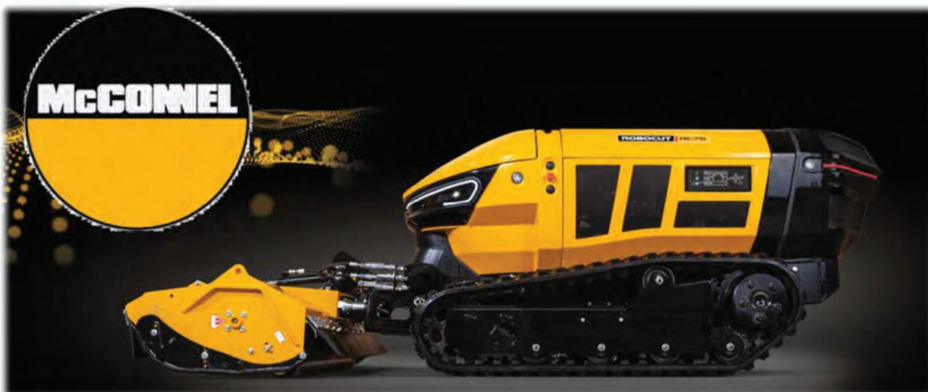
**Der Robocut RC56 und RC75** sind ferngesteuerte Geräteträger für höchste Flächenleistung in hängigem Gelände.
